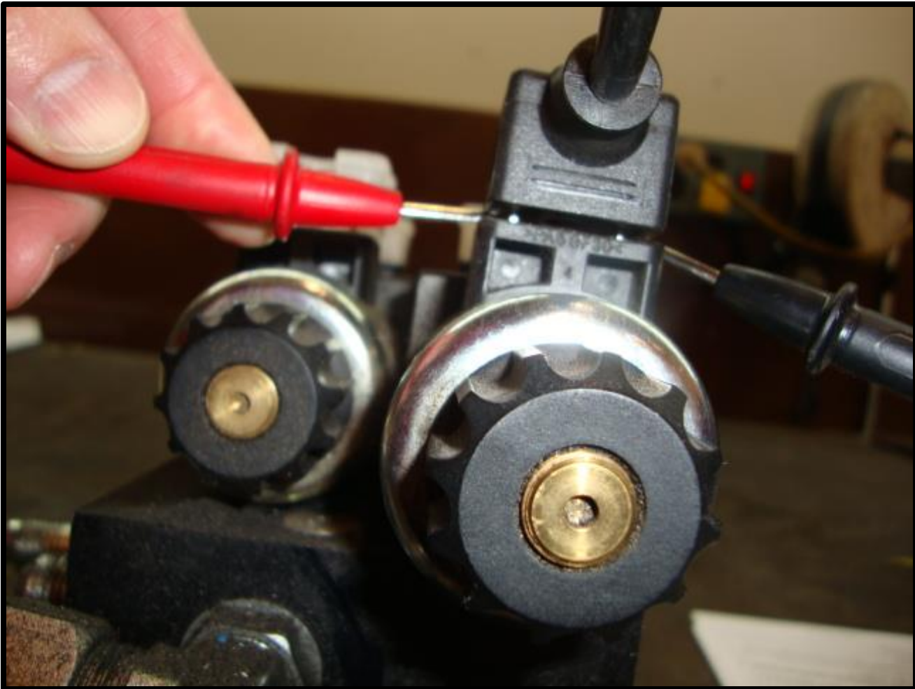
Fig. 8.4 Checking Din Plug Voltage
